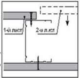
7. Заделка швов между плитами и грунтовка. Обработка швов панелей — одна из важнейших операций строительства «сухим» способом. Обработка швов производится тогда, когда не ожидается изменение влажности или температуры в помещении. С торцевых кромок панелей снимается фаска под определенным углом, а выступающий край с лицевой стороны обрабатывается до шпаклевки. Со швов должна быть удалена пыль, а возможные
